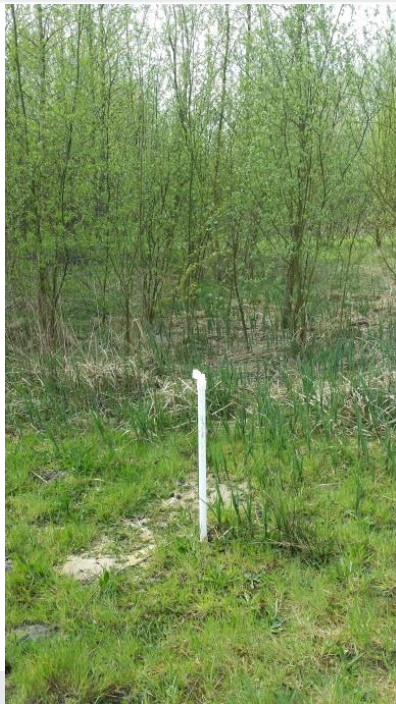
Foto: Monitoringsvoorziening kwetsbaar: peilbuis zonder mantelbuis.
